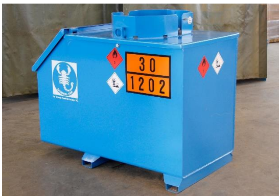
Baustellentank gekennzeichnet mit Gefahrzettel (4 Seiten) und oranger Tafel (2 Längsseiten)
